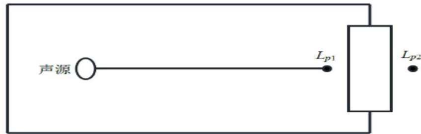
图 4-3 室内声源等效为室外声源图例
